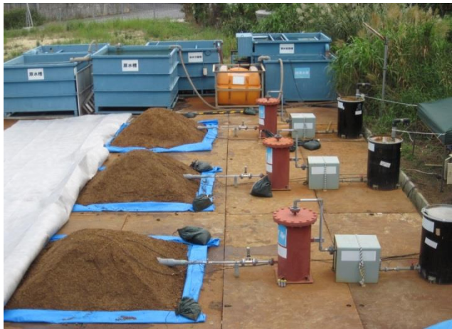
写真-1 バイオパイル写真 (写真上から A, B, C)
